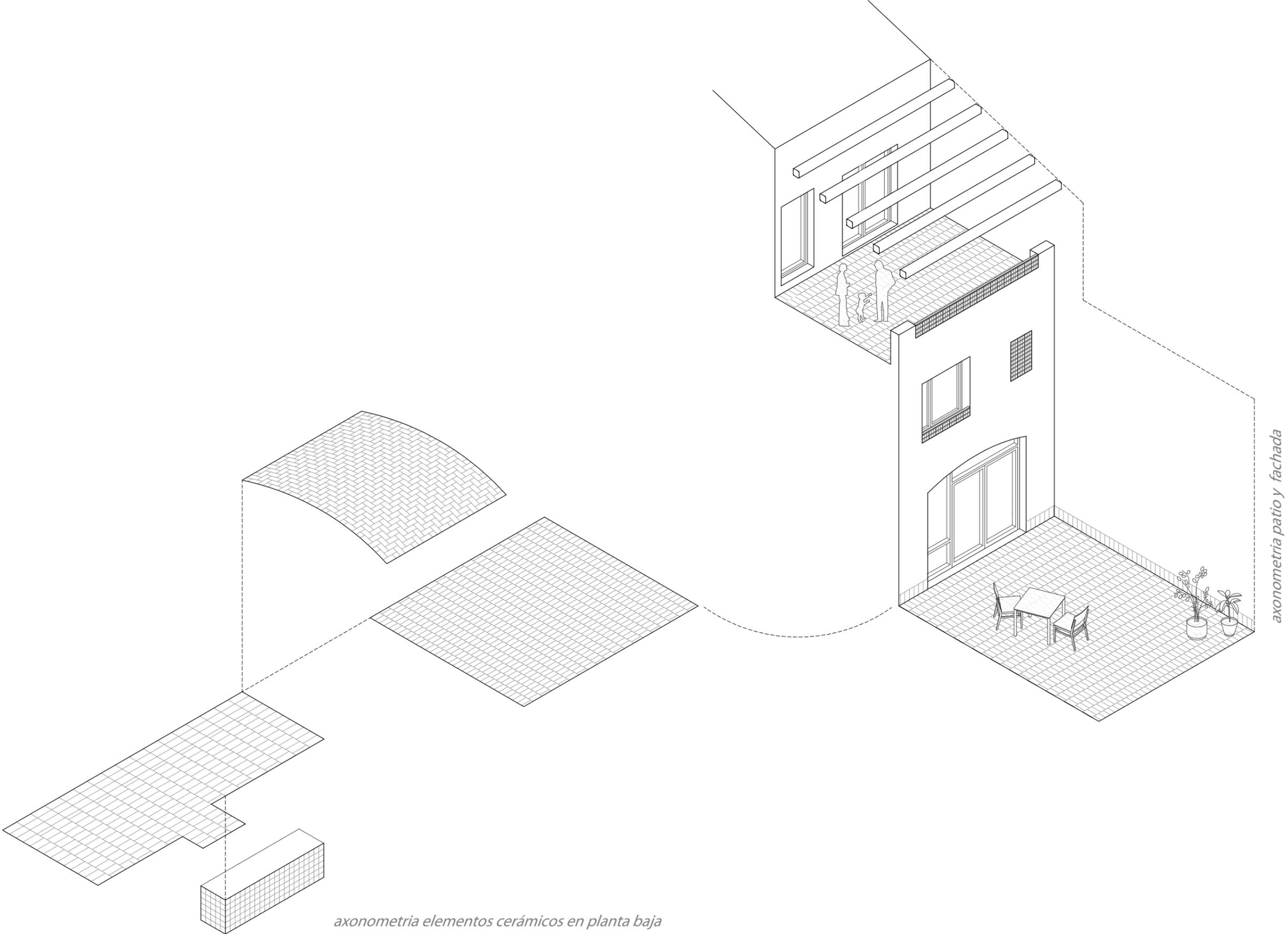
*axonometria elementos cerámicos en planta baja*
